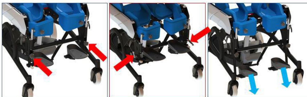
рис. 15 Регулирование подножки по высоте
