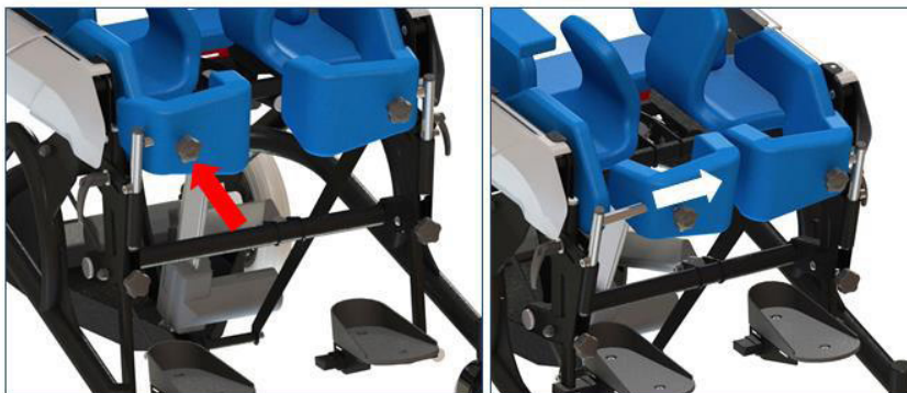
рис. 19 Регулирование упоров для коленей
