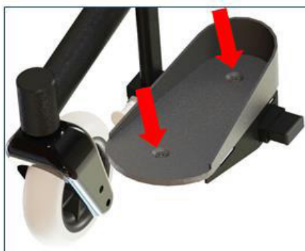
рис. 16 Регулирование угла и положения платформы для ног
